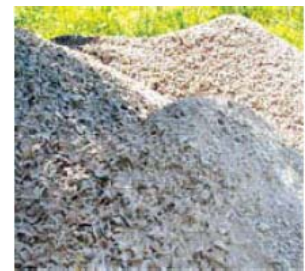
그림 3. MLM 설치전 Fitchburg RTO 에서 제거된 Saddle
